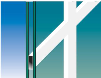
Sprossen bzw. Sprossen die innerhalb des Isolierglases liegen und so die Fensterreinigung besonders erleichtern.
